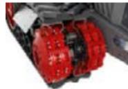
2041 kg : 36 masses pour roues de guidage (9x par roue de guidage)
