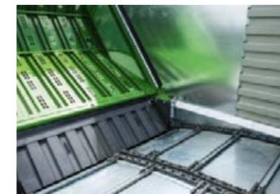
Pour protéger le rotor contre la corrosion et la contamination du maïs, la Fendt Tigo est dotée d'une tôle de recouvrement du canal, à monter rapidement et sans outils.
