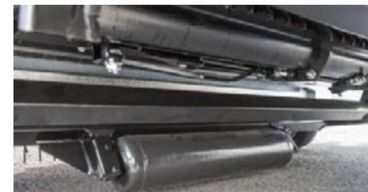
Le rouleau palpeur installé au centre du pick-up, derrière celui-ci, maintient en permanence la hauteur de ramassage définie et garantit un guidage sûr du pick-up, même sur terrains accidentés.
