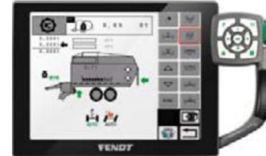
Commandez aussi la paroi frontale et la rampe de couteaux au terminal. Depuis le terminal, vous pourrez même commander le pick-up et le timon hydraulique.
