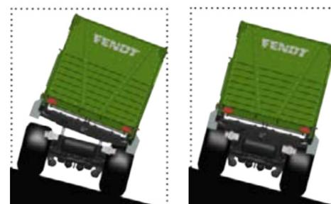
Sans l'alignement au sol automatique, l'autochargeuse s'incline vers l'avant ou sur les côtés, en fonction de la charge et de la vitesse de braquage (voir l'illustration sur la gauche). Avec l'alignement au sol automatique du stabilisateur FSC, l'autochargeuse reste toujours parallèle à la pente. En fonction de la charge transportée, l'autochargeuse règle en permanence sa hauteur optimale de châssis (voir l'illustration sur la droite).
