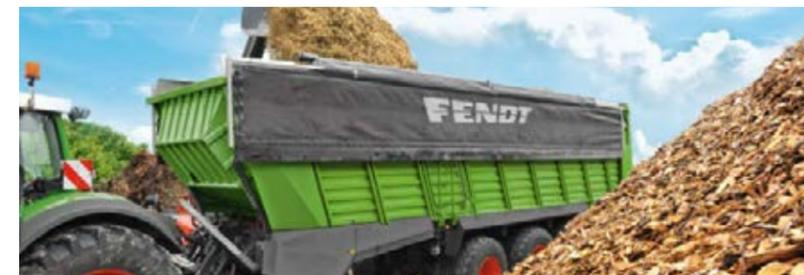
Le design de la Fendt Tigo sans cadre tubulaire facilite le chargement par le haut, que ce soit avec un chargeur ou une ensileuse.
