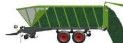
VarioFill : la combinaison d'un chargement et déchargement automatiques intelligents et d'une paroi frontale multifonctions.
