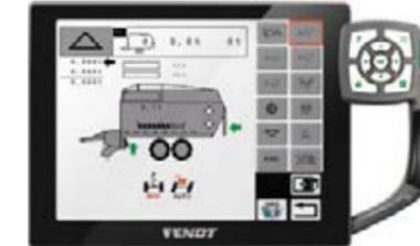
Avec la fonction TIM ready, la Tigo XR peut régler la vitesse du tracteur en fonction de la densité de l'andain et de la capacité du pick-up.
