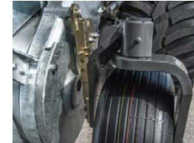
Les 7 rangées de dents, écartées de 54 mm chacune, sont entourées de garants en plastique extra dur. Le pick-up avec des garants plastique garantit les meilleures performances de ramassage et un flux de récolte idéal, grâce à la réduction des pertes par frottement.
