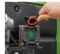
□ Prise ISOBUS pour raccordement de l'unité de commande d'outils.
