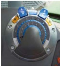
Fonctionnement intuitif avec module de commande du relevage compact (EHR) et commandes de Pdf.
