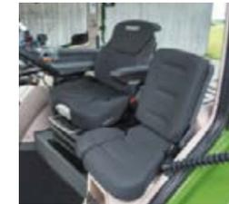
□ Le siège passager confort a une forme ergonomique et est doté d'une assise rembourrée supplémentaire. Il possède une ceinture de sécurité et, lorsque le siège est replié, il peut servir de plateau avec porte-documents.
