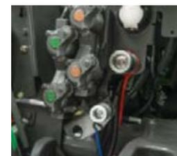
□ Le dispositif Power Beyond est disponible à l'arrière du tracteur pour actionner les machines exigeantes en hydrauliques et disposant de leurs propres régulateurs. Toute la puissance hydraulique est à la disposition de l'outil, sans consommation de puissance inutile. Le circuit de retour libre composé de conduites de grand diamètre présente une faible résistance.
