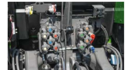
Situés à l'arrière, les raccords hydrauliques sont décalés et identifiés par un code couleur pour une accessibilité parfaite et un accouplement d'une seule main. Les volets anti-poussières se ferment automatiquement grâce à un mécanisme à ressort.
