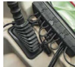
■ Le passage de câble intégré empêche la saleté, l'eau et la poussière de pénétrer dans la cabine. Le joint maintient également le bruit à l'extérieur.
