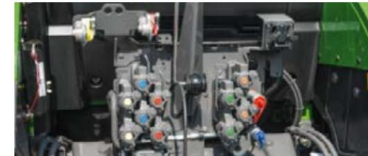
■ Les distributeurs hydrauliques du Fendt 500 Vario peuvent toujours être désaccouplés sous pression. Les distributeurs permettant la connexion sous pression des deux côtés, disponibles en option, permettent un accouplement facile grâce à leur levier.
