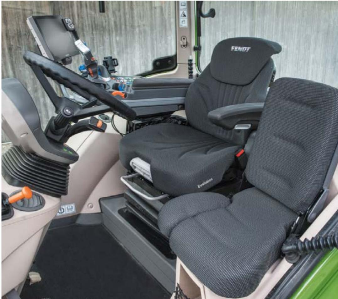
■ pour une position de conduite optimale, le volant et le tableau de bord doivent être réglés à la bonne hauteur et au bon angle d'inclinaison. C'est pourquoi tous les éléments de la cabine du Fendt 500 Vario peuvent être réglés individuellement par la pédale.
