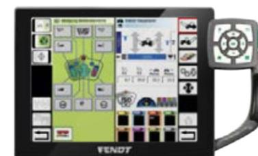
Commande d'outils ISOBUS depuis le terminal et le joystick : l'interface ISOBUS disponible en option permet de piloter tous les outils compatibles ISOBUS directement à partir du terminal Vario. Vous n'avez donc pas besoin de terminaux supplémentaires pour les outils. Le joystick Vario peut également intégrer jusqu'à 10 touches de commande. Cela vous permet de contrôler facilement l'outil avec le joystick multifonctions.
