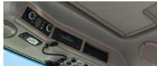
■ Le système de climatisation intégré de série veille à la température idéale. Un système de climatisation automatique est disponible avec les variantes Profi et ProfiPlus.
