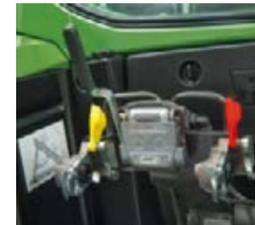
□ Le coupleur à air comprimé Duomatic permet un accouplement rapide des conduites pneumatiques.
