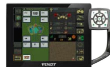
En mode nuit, la luminosité de l'écran est atténuée pour maintenir l'éclairage à un niveau agréable pour l'opérateur. Grâce à l'affichage alternatif, les réglages et les icônes sont faciles à voir.
