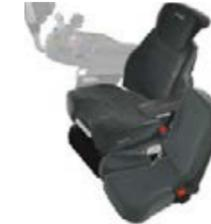
□ Le siège super confort Evolution Dynamic offre les mêmes avantages que le siège super confort, avec en plus un amortisseur latéral et la climatisation. La suspension est ajustée pneumatiquement et alimentée par l'air du compresseur du tracteur, de manière à adapter idéalement sa hauteur et son comportement au poids du conducteur.
