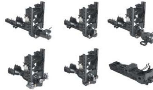
□ Le 500 Vario propose 6 systèmes d'attelage bas au choix : cat. rétractable 3 barres oscillantes et barres déportées, crochet d'attelage classique, piton fixe renforcé et attelage à boule.
