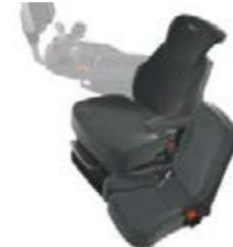
■ Le siège confort est à suspension pneumatique et le réglage de l'accoudoir est d'une simplicité enfantine.
