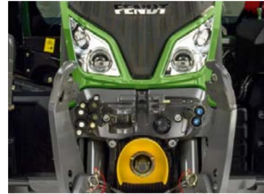
**Connexions à l'avant :** troisième point, 2 distributeurs double effet, retour libre avant, prise à 7 broches, prise de force avant en option 1 000 tr/min, relevage avant en option ; en option : contrôle de position électronique, contrôle de position et report de charge
