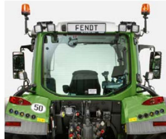
Outre les feux arrière classiques, l'éclairage arrière du tracteur comprend des phares de travail intégrés au toit (LED en option), ainsi que d'autres phares de travail (LED en option), montés sur les garde-boue.
