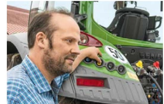
■ Le relevage arrière, la prise de force et les distributeurs hydrauliques peuvent également être commandés de l'extérieur, depuis les deux garde-boues arrière. Ce qui facilite nettement le processus d'attelage des outils.
