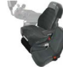
□ L'appui-tête du nouveau siège Super Confort Evolution Dynamic pivote en même temps que le conducteur, lorsqu'il regarde vers l'arrière, pour lui apporter plus d'aisance et de confort. Le siège est également entièrement équipé d'un chauffage de l'assise, d'une climatisation et d'une suspension pneumatique.
