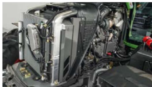
Moins d'effort, plus de temps libre : le bloc de refroidissement compact est facilement accessible et facile et rapide à nettoyer, grâce à l'écart important entre les échangeurs et le plancher plat du bloc de refroidissement.
