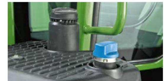
Le 500 Vario est équipé d'un réservoir pouvant contenir 298 l de carburant pour une plus grande autonomie de fonctionnement. Le réservoir d'AdBlue, d'une contenance de 31 litres, est parfaitement intégré au réservoir de carburant. Les goulots de remplissage sont situés du même côté du tracteur.
