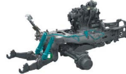
Le relevage avant est parfaitement intégré au demi-châssis, flasqué au tracteur. Cela permet aux machines attelées d'être extrêmement maniables. Les bras inférieurs se distinguent par une grande course et se replient facilement pour le transport. Des soufflets protègent les vérins de relevage des projections. L'amortisseur par boule d'azote installé de série évite les à-coups et offre une sécurité ainsi qu'un confort de conduite exceptionnels.
