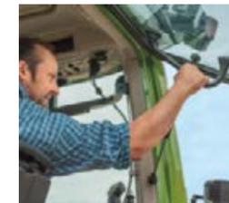
■ La poignée verticale de la lunette arrière est une spécificité du Fendt 500 Vario qui permet d'ouvrir et fermer simplement la fenêtre, tout en restant assis.
