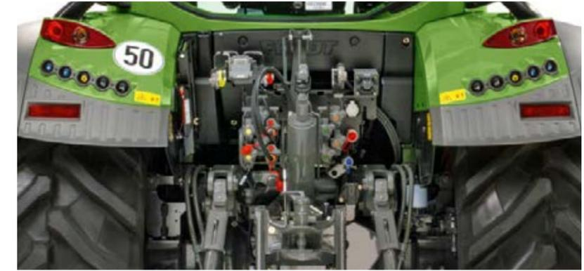
**Connexions arrière :** prise signal LS, connexion ISOBUS, troisième point hydraulique, cinq distributeurs double effet, retour libre arrière, frein pneumatique, pression de pilotage Power Beyond, frein hydraulique de remorque, prise à 7 broches, stabilisateurs à recentrage automatique, prise ABS, prise de force arrière (de série : 540 / 540E / 1 000 ; en option : 540E / 1 000 / 1 000E), chape d'attelage, attelage bas
