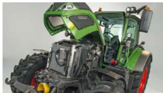
Le compartiment moteur est très facile d'accès pour pouvoir effectuer aisément les contrôles et les interventions d'entretien, même lorsque les pièces de fixation du chargeur frontal sont en place. Le capot d'un seul tenant avec deux panneaux latéraux séparés peut être ouvert avec facilité.
