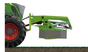
Les faucheuses à tambours Fendt Cutter FZ à système à parallélogramme s'adaptent parfaitement au terrain avec une course maximale de 490 mm, et traitent délicatement le sol avec leur large surface d'appui.
