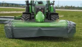
Avec une oscillation de +/- 5°, la faucheuse Fendt Cutter FPV suit parfaitement le terrain, pour une coupe parfaitement régulière.
