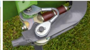
Le dispositif de sécurité anticollision protège la faucheuse en cas de choc, et se reverrouille automatiquement lors du passage en marche arrière.
